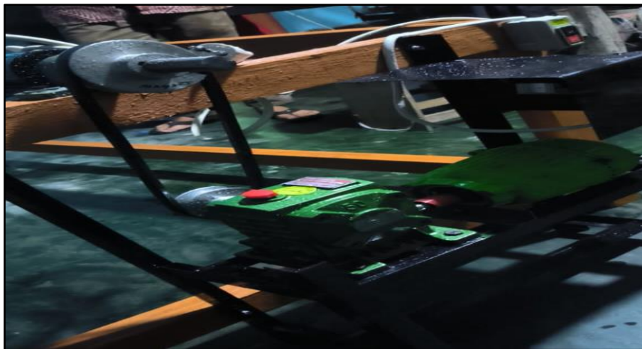
Gambar 2. Pemasangan Inovasi Mesin Penggulung Tenun
