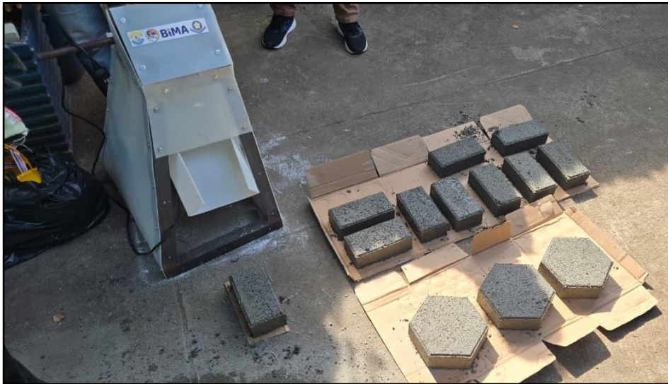
Gambar 7. Proses Curing Paving Block yang Sudah Selesai di Cetak dengan Material Campuran Plastik
